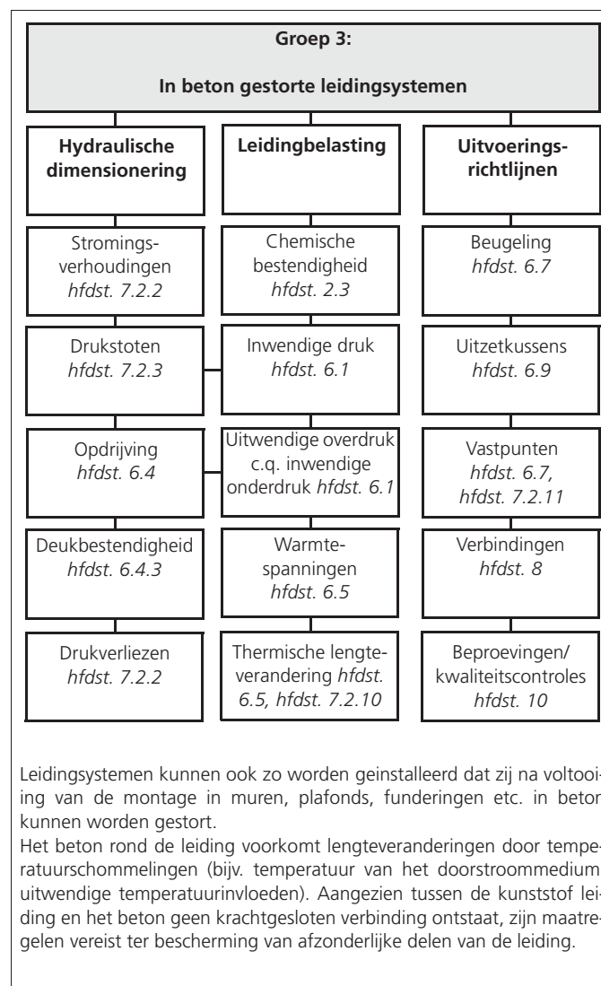
Afbeelding 5.5 In beton gestorte leidingsystemen
