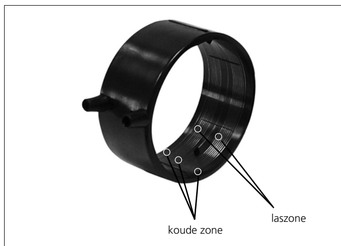
Figuur 5.13 Elektrolasmof met warme en koude zones
