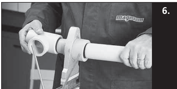
6. Controleer de lastemperatuur op het warmteelement en steek de leiding en mof met de hand in en over de lasmof en lasdoorn. Gedurende de verwarmingsperiode de beide delen zonder druk vast te houden.
